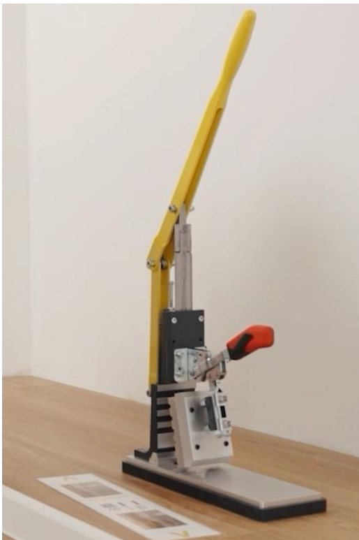
FN GILOTYNA Do montażu listew rdzeniowych
